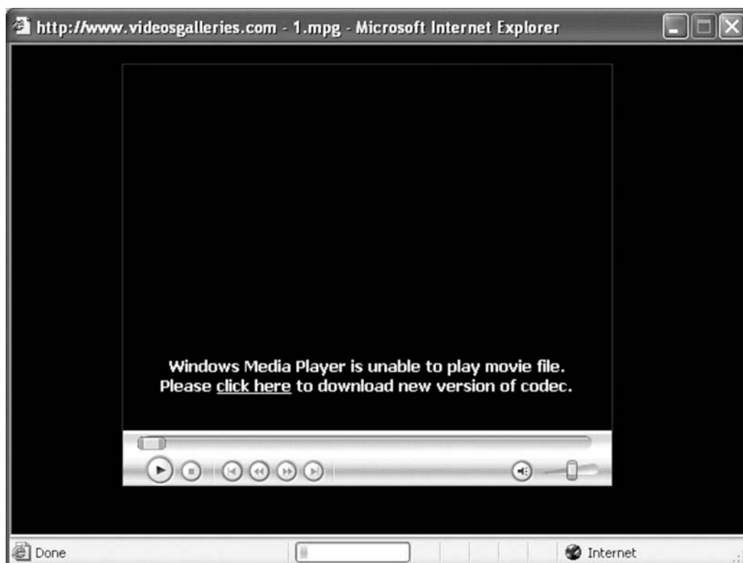
Rysunek 3.1. Malware można skutecznie maskować pod postacią niewzbudzającego podejrzeń odnośnika do pluginu Media Player
